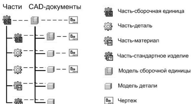
Рис. 1. Пример схемы ЭСИ
