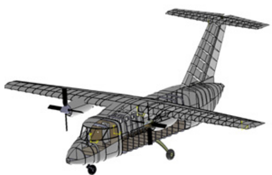
Рис. 1. Параметризованная 3D-модель легкого пассажирского самолета
