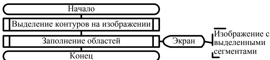
Рис. 5. Схема работы подсистемы сегментации изображения
