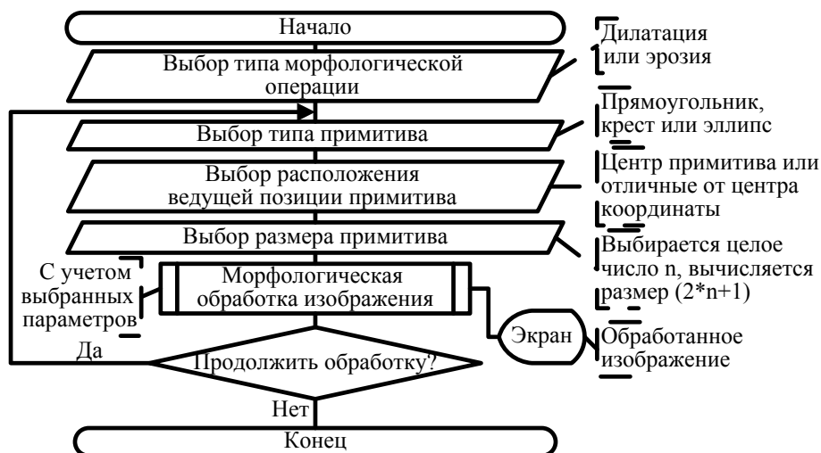
Рис. 4. Схема работы подсистемы морфологической обработки изображения
